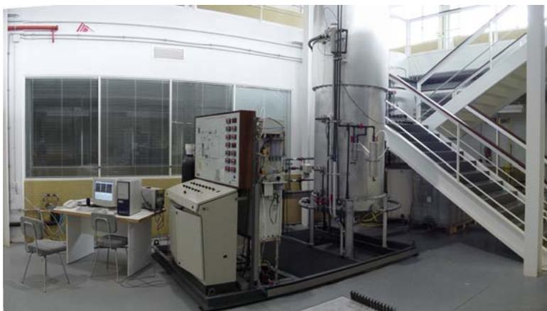
Figura 4.10 Imagen del reactor UASB-UAF.
